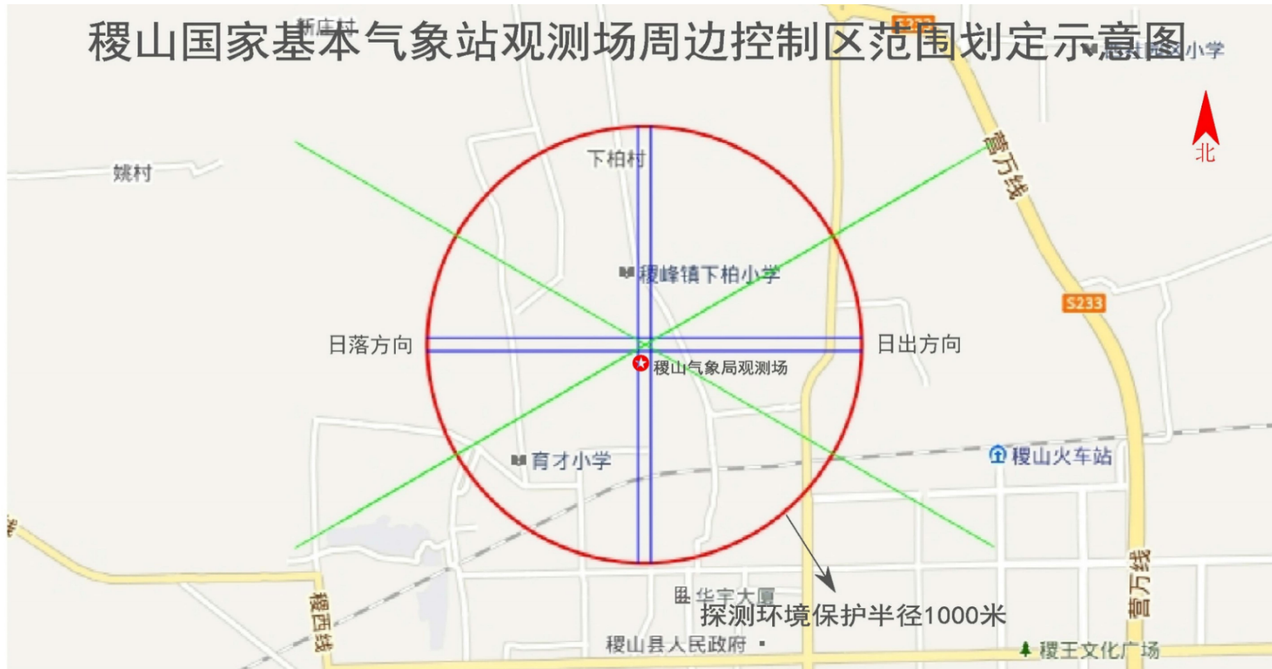
附图3 稷山国家基本气象站观测场1000米控制范围划定示意图
